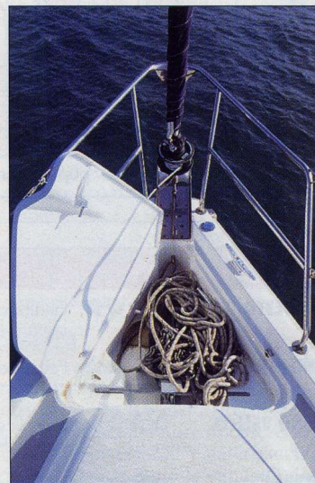
Il gavone dell'ancora, dotato di sede per la Danforth di serie.
