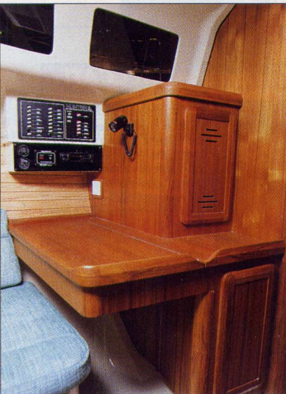
Il carteggio dispone di un armadio cerate e un vano per gli attrezzi.
